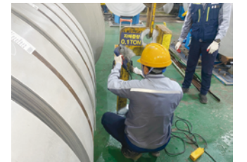
크레인 달기기구 비파괴 검사 (세아제강 창원공장)
